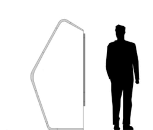
*La fresque installation est un projet de structure auto-portante dessinée par l'agence Oikos pour des installation muséales. Une maquette a été réalisée sur le principe de la structure. Un bureau d'étude doit valider sa faisabilité pendant la phase de production.*
